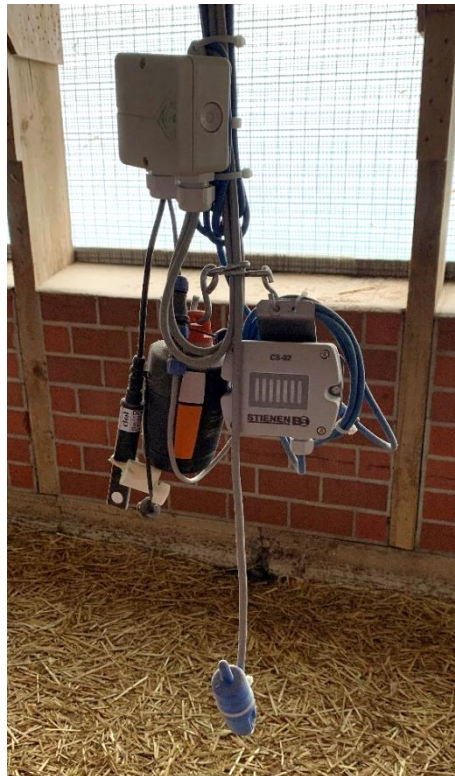
Abbildung 14: Messtechnik zur kontinuierlichen Erfassung der Klimadaten auf dem Fokusbetrieb (Temp., rel. Luftfeuchtigkeit, CO 2 , NH 3 )
