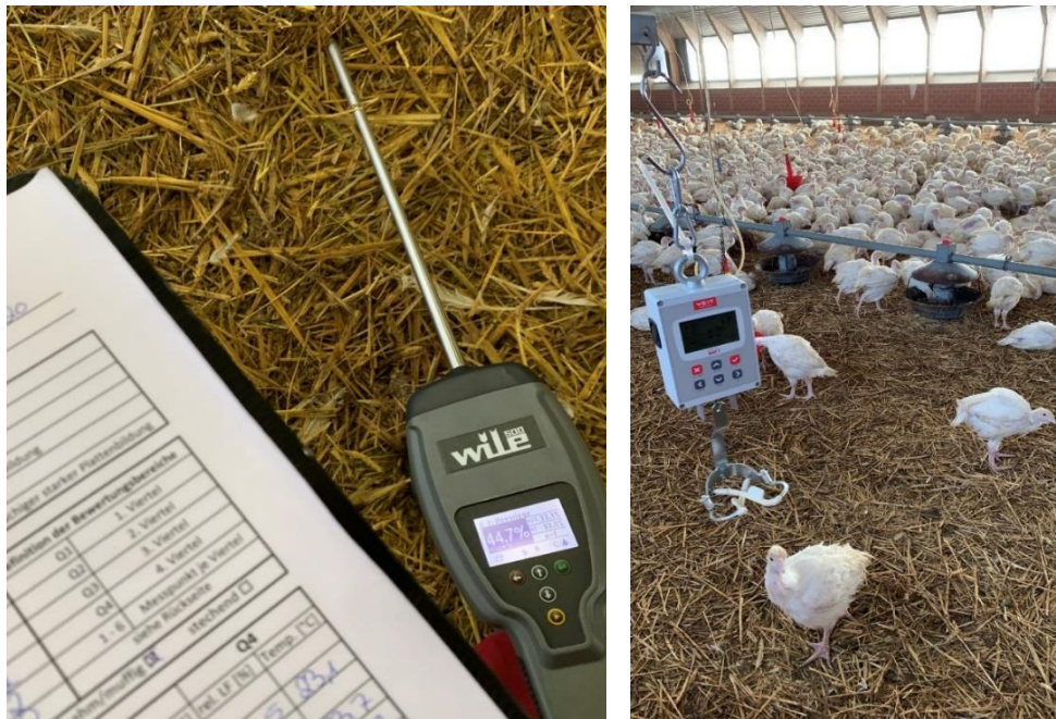
Abbildung 12: Messtechnik zur Erfassung der Einstreufeuchte und -temperatur (links) und der Tiergewichte (rechts).
